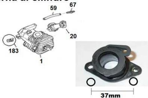
**2^ versione con presa impulso sulla luce di aspirazione del cilindro**
