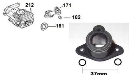
**4^ versione con cilindro con attacco per la terza vite**
