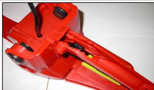
cod. 4503806 Impugnatura acceleratore **senza** pulsante di blocco dell'acceleratore
